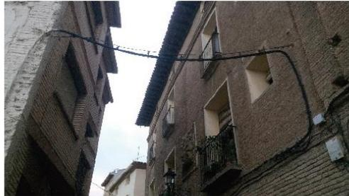
**Figura 3.9.** Red aérea tensada con cable de acero.
