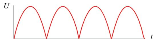
Figura 19.5. Aspecto de la tensión continua que se presenta a la salida del colector con dos delgas.
