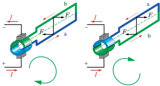
**Figura 19.34.** Gracias al colector de delgas se consigue que la corriente y la fuerza que aparece en los conductores del rotor sea siempre del mismo sentido.
