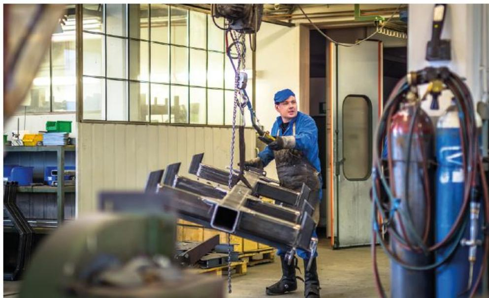
**Figura 8.2.** Soldador desplazando un subconjunto de estructura soldada con un puente grúa. El soldador forma parte del mantenimiento de **primer nivel** del puente grúa.
