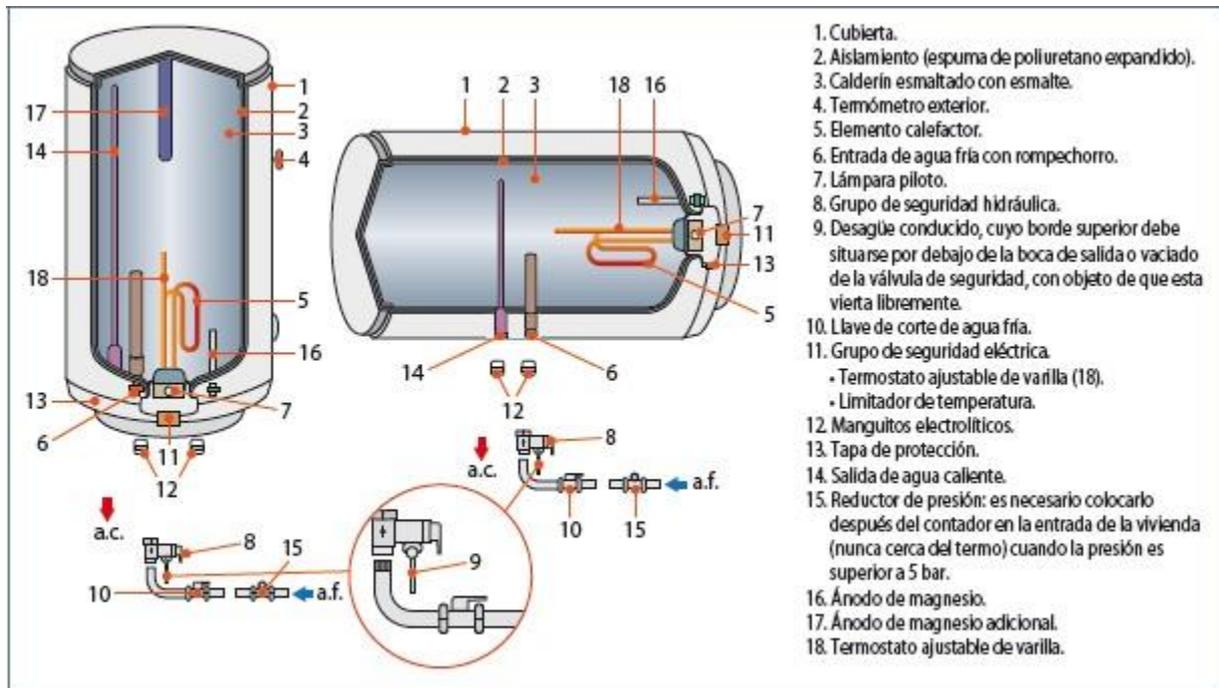
**Figura 8.2.** Diagrama interior de un termo eléctrico para instalación vertical y horizontal.
