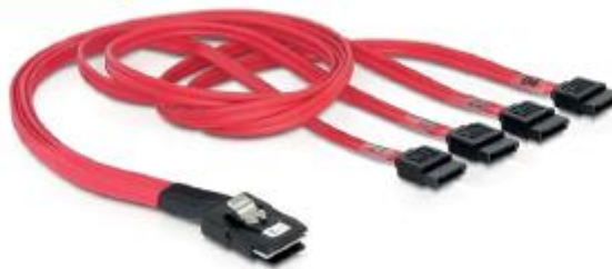
Figura 3.60. Cable SAS multicanal con un conector SFF-8087 y cuatro SFF-8482 en el otro extremo.
