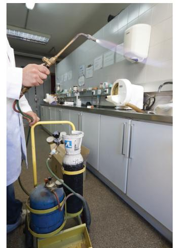
Figura 2.21. Soldadura fuerte de oxibutano.
