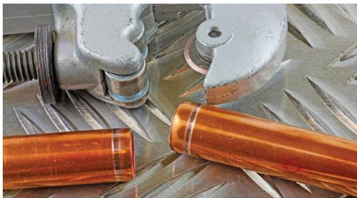
Figura 2.18. Tubería de cobre cortada con cortatubos.
