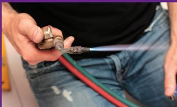
El soplete es el elemento de la soldadura que efectúa la mezcla de gases. Las partes principales del soplete son las dos conexiones con las mangueras, dos llaves de regulación, el inyector, la cámara de mezcla y la boquilla.
