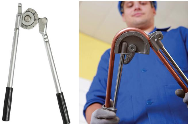
Figura 2.19. Curvadora para tubería de cobre (izquierda) y manejo de la herramienta (derecha).
