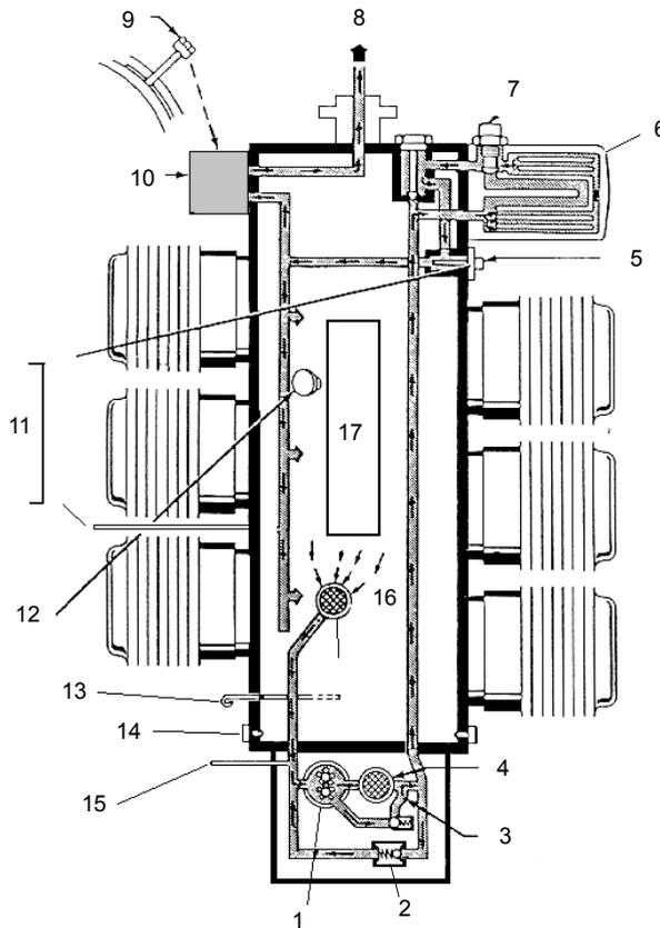
Fig. 8.3. Esquema de sistema de lubricación de cárter seco. Motor de seis cilindros horizontales y opuestos.
