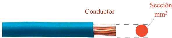
Figura 4.2. Sección de un conductor.
